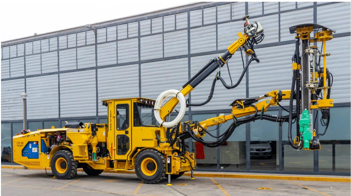
Equipo para instalación mecanizada de perno cable, fortificación en secciones medianas desde 4x4 hasta labores de 7 m de altura.
