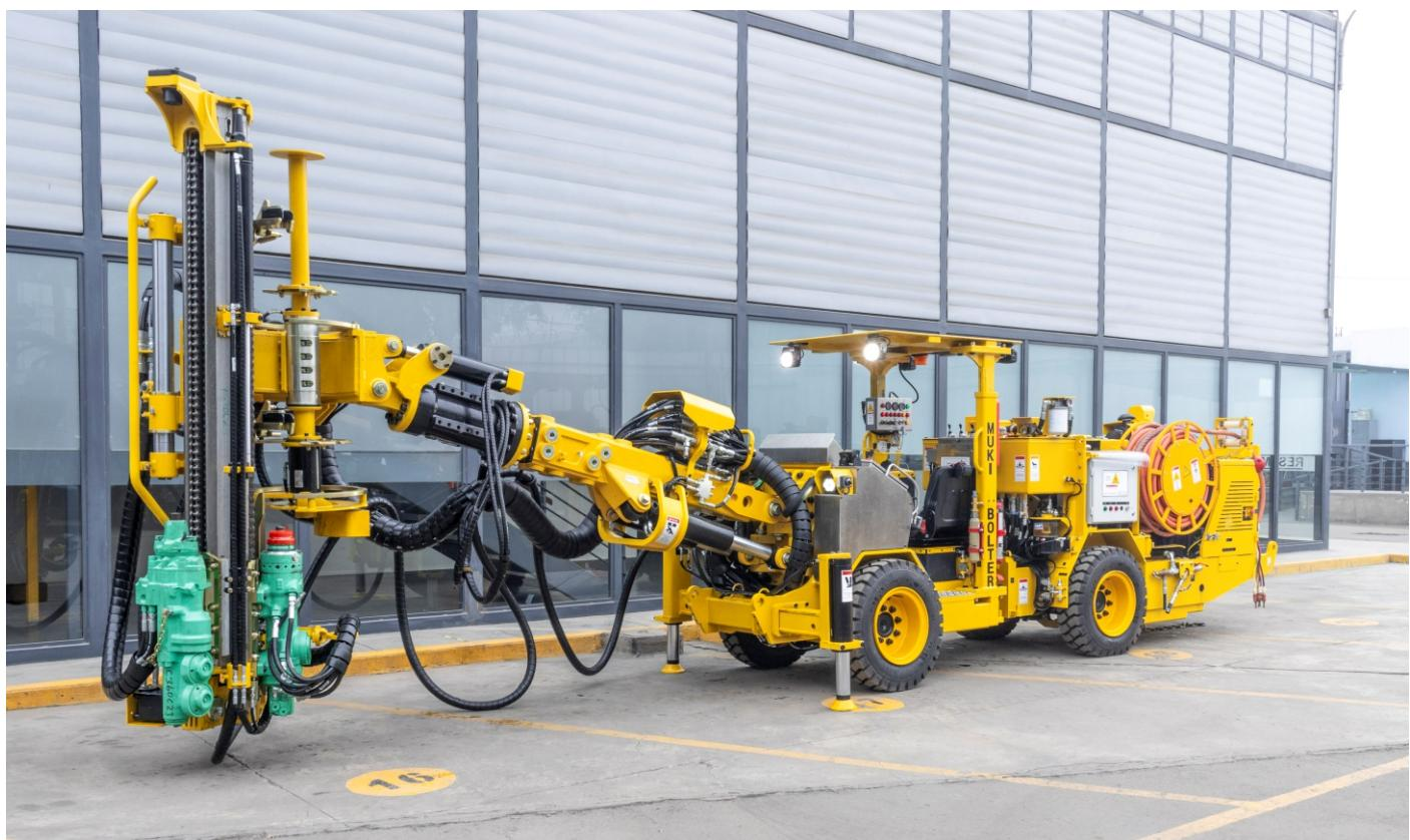
*MUKI BOLTER para fortificación y enmallado mecanizado, permite reforzar de manera eficiente y segura las estructuras de los techos en las minas subterráneas, ideal para secciones desde 2.7 x 2.7 m. hasta labores de 5 m de altura.*
