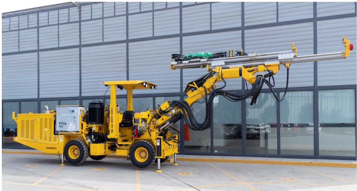
TROIDON 44 XP es un jumbo de perforación frontal de 1.30 m de ancho recomendado para secciones pequeñas desde 2.50 m x 2.50 m hasta 4.50 m x 4.50 m.
